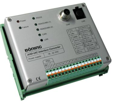
Unidade micro-processada de design compacto para conversão de protocolos Entradas: Duas interfaces para protocolo Modbus RTU Saída: CAN bus para rede Böning AHD-SAS Configuração customizável
