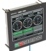
CAN-Bus der Hilfsmaschinen- und Generatorüberwachung
