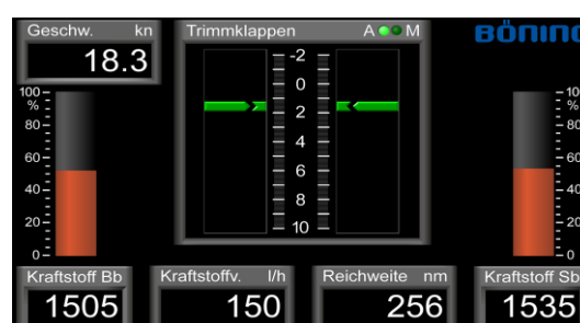
Seite 2: Trimmklappenwinkel, GPS-Geschwindigkeit, Reichweite, Kraftstoffverbrauch, Tankinhalte
