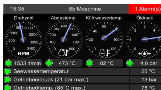
Seite 1: Werte und Statusanzeigen eines Motors
