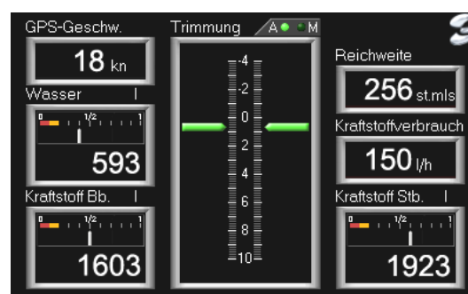
Seite 2: Trimmklappenwinkel, GPS-Geschwindigkeit, Reichweite, Kraftstoffverbrauch, Tankinhalte
